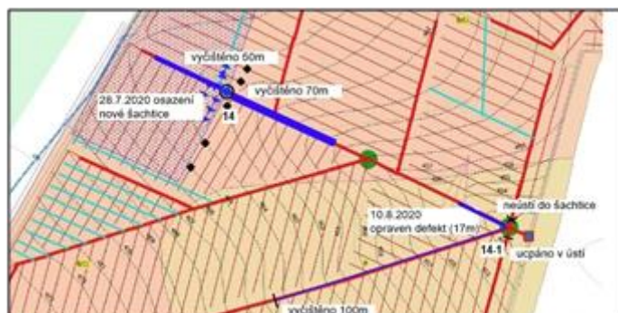
Obr. 26 Přehledová mapa drenážní skupiny 14 se zakresleným místem instalace RP v kontrolních šachticích přebudovaných ze šachtic podzemních Šn (zelené puntíky), vyznačením dosahu pročištění svodných drénů a vyznačením plánu pro budoucí instalaci podzemních regulačních prvků systému PRO (viz TNV 75 4221)
