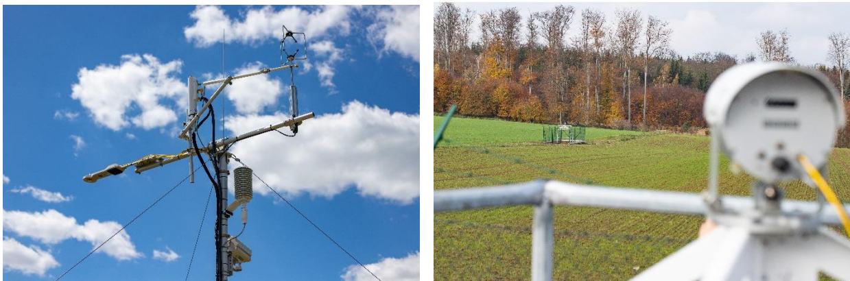
Obr. 14 Zařízení Eddy covariance a scintilometr, přístroje určené k měření evapotranspirace
