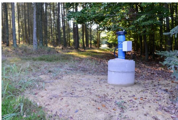
Obr.12 Geologický monitorovací vrt vybavený tlakovou sondou pro monitorování hladiny podzemní vody a vpravo půdní vlhkostní čidla TMS4
