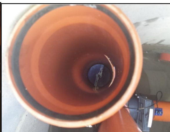
Obr. 31 Do šachtic drenážní skupiny 1 a 14 byly umístěny regulační prvky a objemové průtokoměry typu tipping-bucket (na dvou obrázcích nahoře). Měření je dále doplněno o průtokoměry rychlostní, v provedení axiálních vrtulek zabudovaných do PVC KG100 (dva obrázky dole) – s osou vertikálně orientovanou (na přepadovém potrubí RP) a horizontálně orientovanou (pro odvodňovací fázi).
