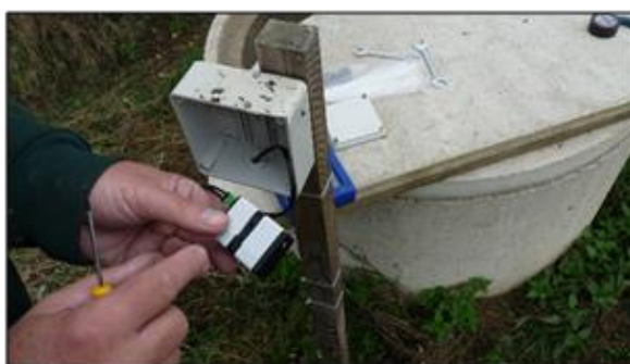
Obr. 31 Do šachtic drenážní skupiny 1 a 14 byly umístěny regulační prvky a objemové průtokoměry typu tipping-bucket (na dvou obrázcích nahoře). Měření je dále doplněno o průtokoměry rychlostní, v provedení axiálních vrtulek zabudovaných do PVC KG100 (dva obrázky dole) – s osou vertikálně orientovanou (na přepadovém potrubí RP) a horizontálně orientovanou (pro odvodňovací fázi).
