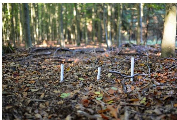
Obr.12 Geologický monitorovací vrt vybavený tlakovou sondou pro monitorování hladiny podzemní vody a vpravo půdní vlhkostní čidla TMS4
