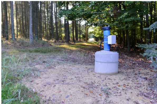
Obr. 2 Geologický monitorovací vrt vybavený tlakovou sondou pro monitorování hladiny podzemní vody a vpravo čidla půdní vlhkosti TMS4
