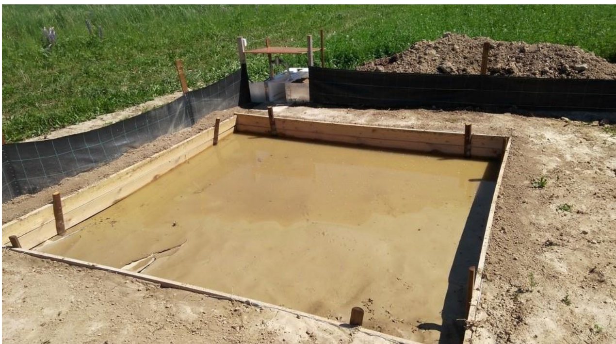
Obr. 17 Množství erodovaného materiálu po usazení a částečném odčerpání vody
