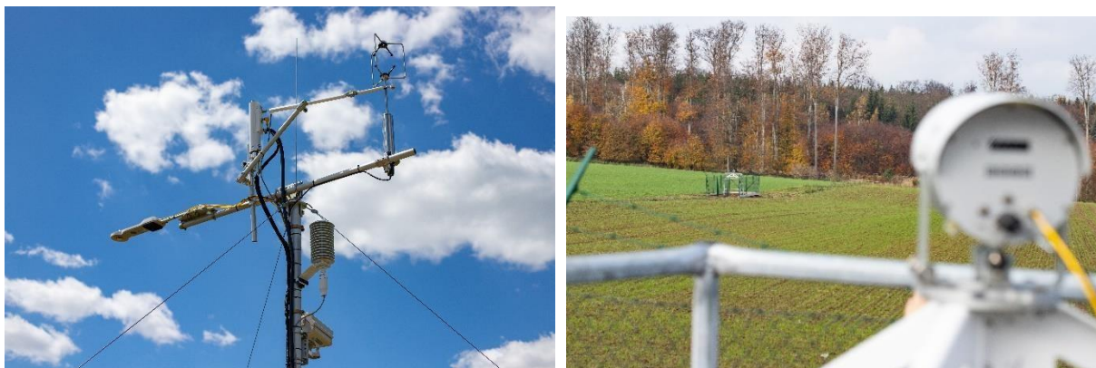
Obr. 8 Zařízení Eddy covariance a scintilometr, přístroje určené k měření evapotranspirace
