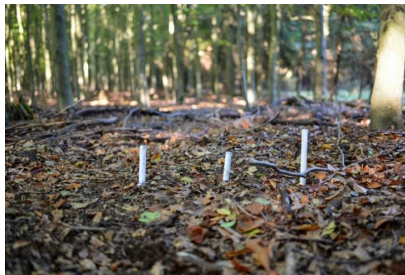
Obr. 2 Geologický monitorovací vrt vybavený tlakovou sondou pro monitorování hladiny podzemní vody a vpravo čidla půdní vlhkosti TMS4
