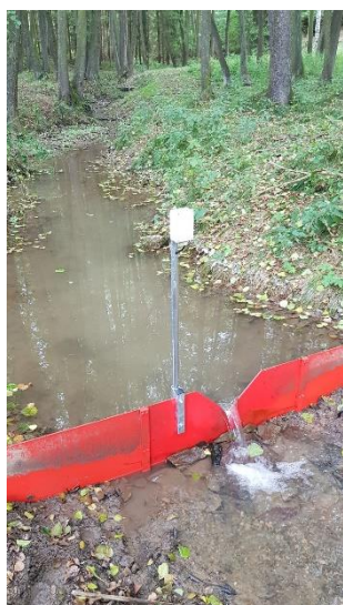
Obr. 11 HOZ ústící do Brejlského potoka vybaven tlakovou sondou s NB IoT přenosem dat
