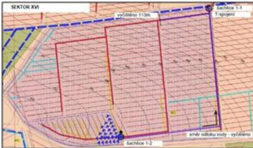
Obr. 28 Přehledová mapa drenážní skupiny 1 se zakresleným místem instalace RP a vyznačením dosahu vzdutí HPV
