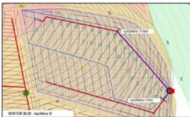
Obr. 34 Přehledová mapa drenážní skupiny 44 (vlevo) – s vyznačením místa kontrolní šachtice a rozvržením plánovaných instalací podzemních regulačních prvků typu PRO (viz obrázek uprostřed a vpravo)
